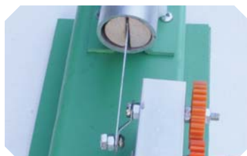
Ročični mehanizem v povezavi z batom
