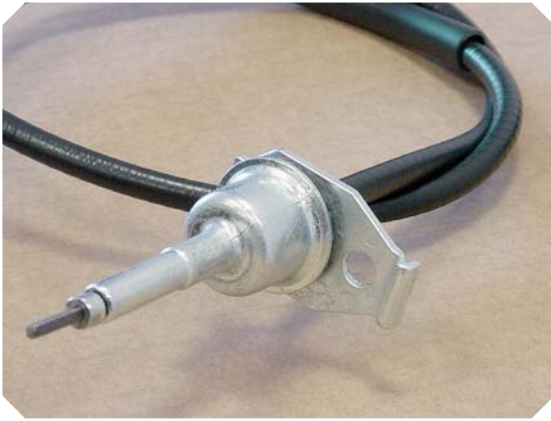
Gibljiva gred za pogon merilca hitrosti pri avtomobilu
