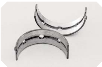
Drсни ležaj motorne gredi avtomobilskega motorja
