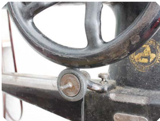
Torno kolo za navijanje sukanca pri čevljarškem šivalnem stroju
