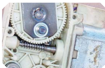
Polžasto gonilo pri mehanizmu avtomobilskih brisalcev
