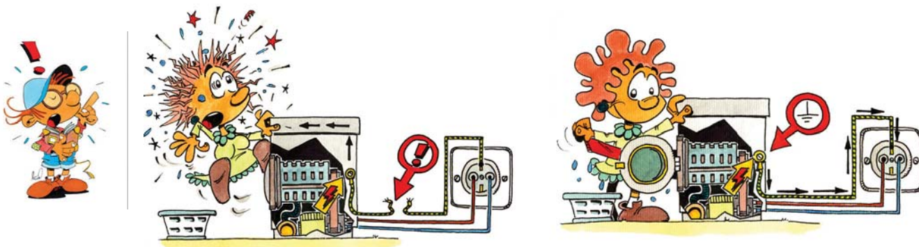
Priključitev ozemljitvenega voda pri porabniku v stanovanju
