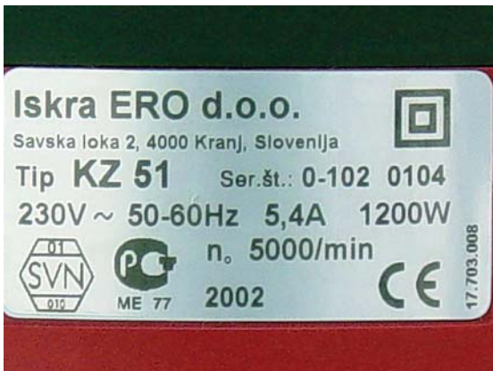
Ploščica vrtalnega stroja s podatki
