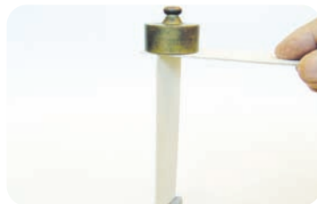
Lepenka je najtrdnjše gradivo, ki se kljub večji obremenitvi ne ukloni.
