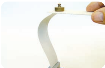
Karton se ukloni pod dodatno obremenitvijo.
