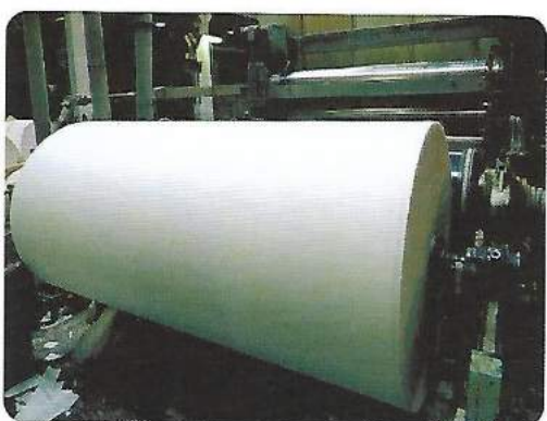
Navijanje papirnega traku v veliko balo
